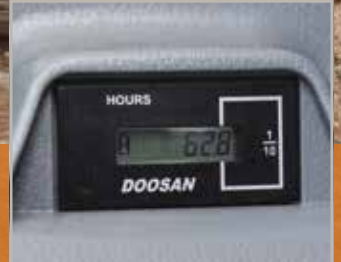
Betriebsstundenzähler (vom Boden aus ablesbar)
