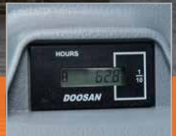
Betriebsstundenzähler (vom Boden aus ablesbar)
