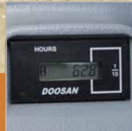
Betriebsstundenzähler (vom Boden aus ablesbar)
