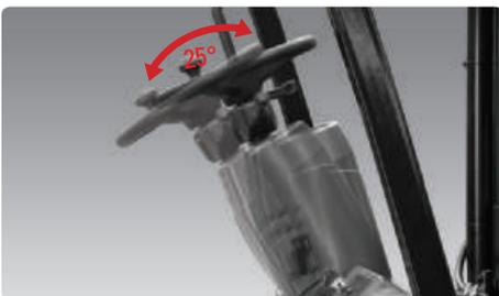
**Einstellbares Lenkrad mit Drehknopf**
