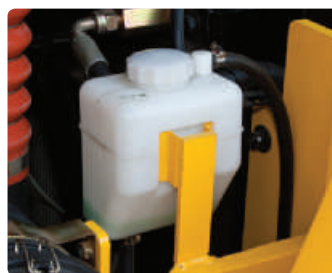
Ausgleichbehälter für Kühlflüssigkeit
