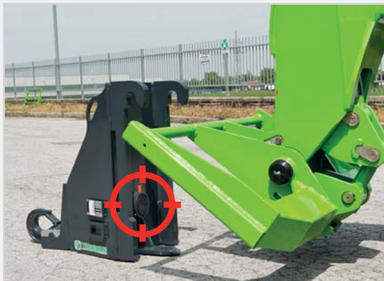
Am Werkzeug angebrachter Sensor
