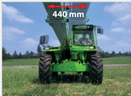
Seitenverschub des Oberwagens
