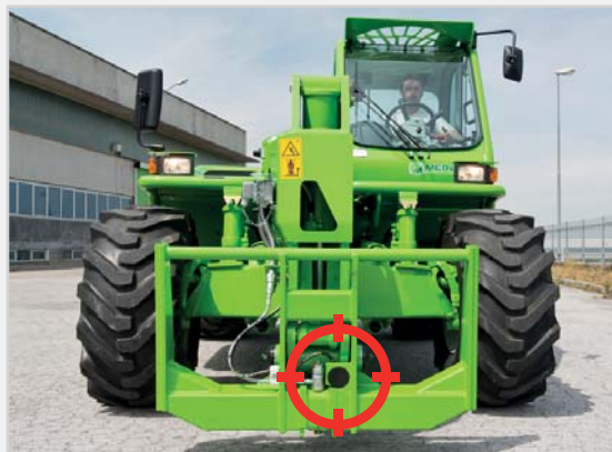
Am Anbaurahmen angebrachter Sensor
