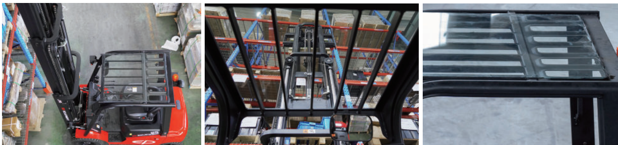
neuen geschlossenen Dach
